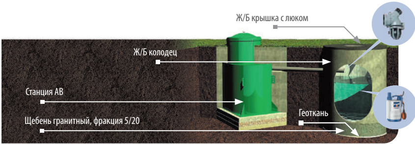
Рисунок 6. Система поглощения, колодец поглощения.
