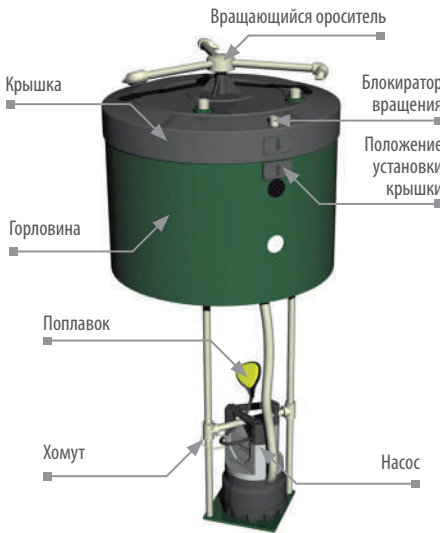
Рисунок 16. Установка циркуляционного насоса Станции.
