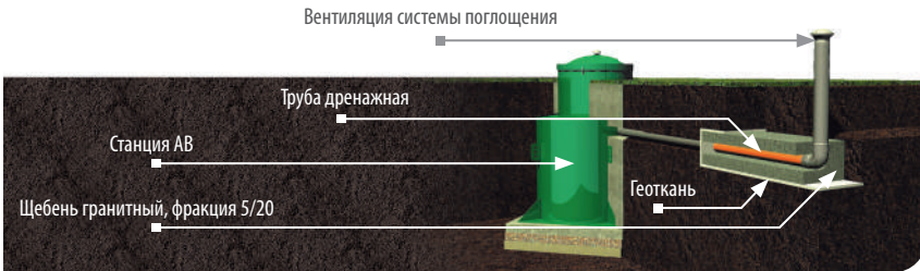
Рисунок 7. Система поглощения, поле поглощения.
