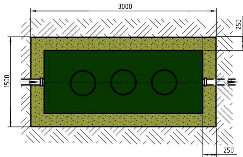
При монтаже оборудования в водонасыщенный грунт с риском обвала котлована следует применять деревянную опалубку. Для изготовления опалубки использовать обрезную доску 50мм.
