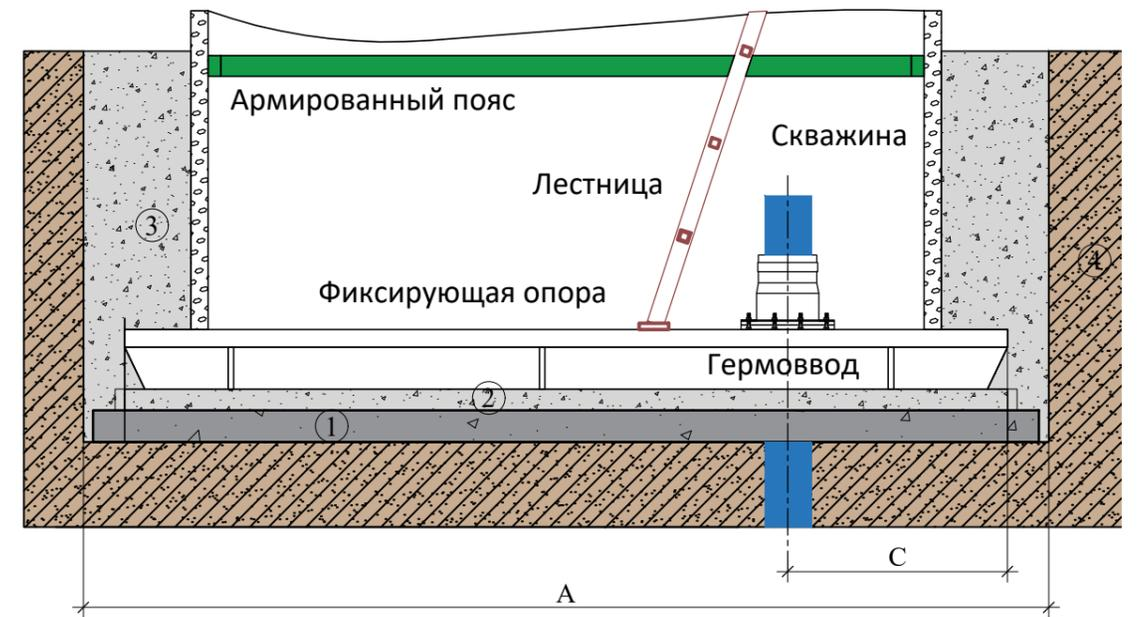
1. Бетонное основание (ж/б плита), толщиной 180 мм
